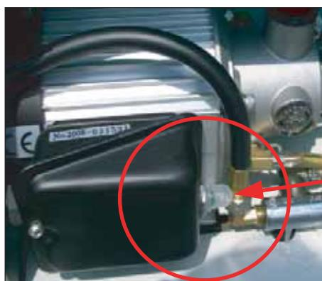
白いカバー内のボタンが飛び出しているとリセットが作動しています。指で軽く押してください。白いカバー内のボタンが左のように押し込まれたらモーターが作動します。
