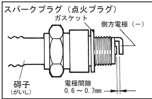
新しいスパークプラグを取り付ける際にトルクレンチが準備できない時は、指でいっばいに締め込んだ後、プラグレンチを使って1/4 ~ 1/2 回転更に締め込んでください。できるだけ早い時期に、トルクレンチを使って正規の値で締めてください。
