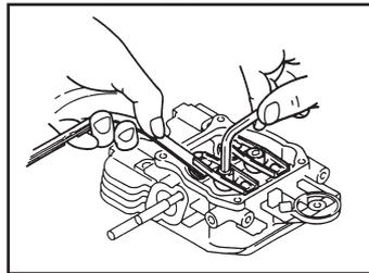
(注)バルブクリアランスの調整後クランク軸を廻して、もう一度バルブクリアランスが適当かどうか測定してください。
