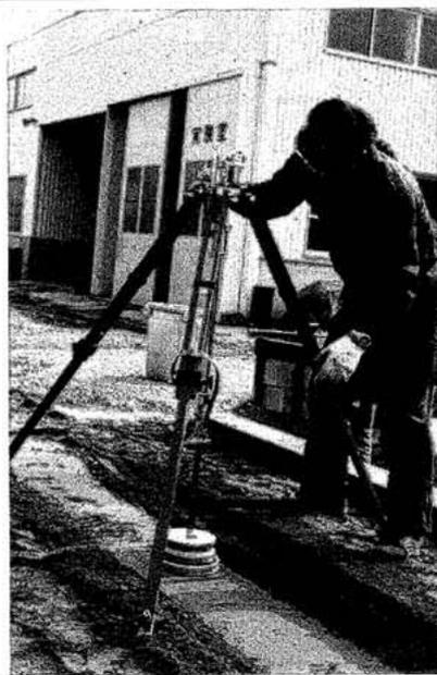
(MTR-80G 型ランマアの締固め試験)
