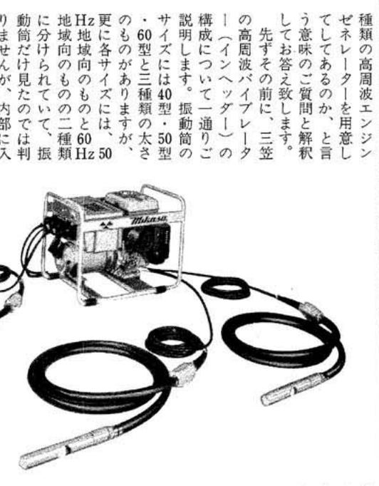
種類の高周波エンジンゼネレーターを用意してあるのか、と言う意味のご質問と解釈してお答え致します。 先ずその前に、三笠の高周波パイプレーター(インヘッダー)の構成について一通りご説明します。 振動筒のサイズには40型・50型・60型と三種類の太さのものがあります。 更に各サイズには、50Hz地域用のものと60Hz地域用のものと二種類に分けられていて、振動筒だけ見たのでは判りませんが、内部に入っている振子の大きさが違つたものを使つています。これは、50Hz地域と60Hz地域とは、周波数が20%違うように、モーターの回転数も同様に約20%だけ60Hz地域の方が早くなるからです。この事は、設計された振子を組付けた振動筒を60Hz地域に持つて行つてそのまま使つたとしますと、120の力を出して結局8対4で第二試合は本社チームに凱歌が上がり、昼食後行われる館林チームとの決勝戦へと駒を進めた。
