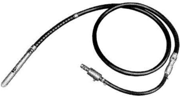
(MVI-HD45型隧道用バイブレーター)
