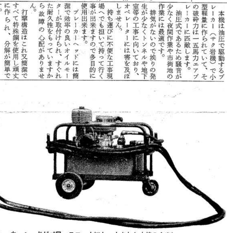
（ブレーカーヘッドがパワーユニットにセットされた本機の全容）
