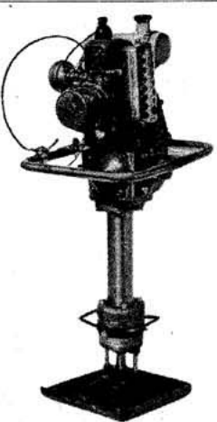
ランマーになった本機
