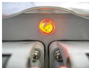
異常電圧時:橙色点滅
