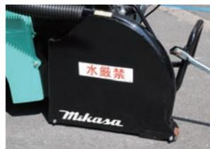
2 路面追従式吸音ブレードカバー
