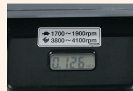
作業・メンテナンスの管理に欠かせないタコ・アワーメーター
